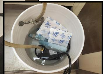
Un montage simple peut être réalisé avec un bac d'eau, des glaces et une pompe d'aquarium.
